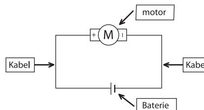
**Baterie:** je zdroj napětí. Obsahuje chemikálie, které projdou chemickou reakcí, aby produkovaly napětí, když je obvod zapojen.
